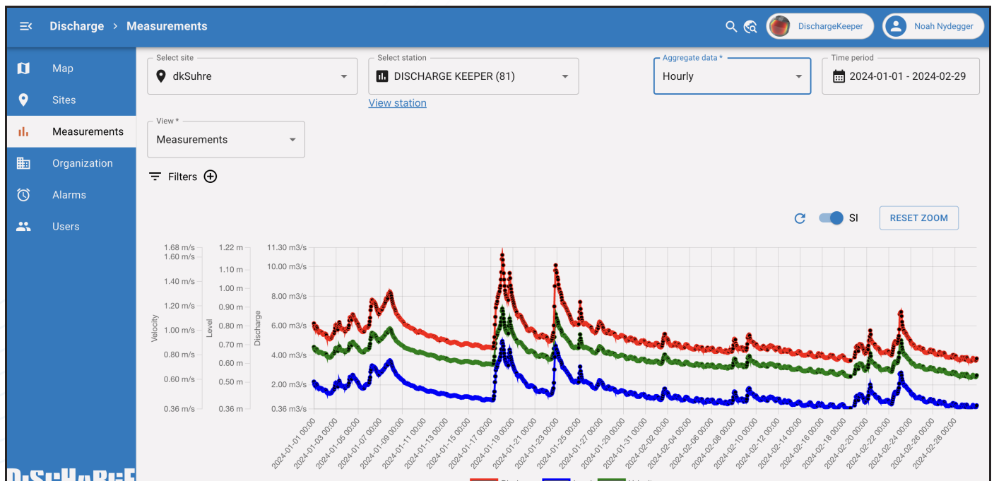
Visualización de las series temporales de las medidas del nivel de la lámina del agua, de la velocidad superficial y del caudal con DischargeDataHub.
