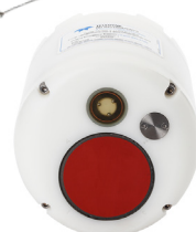
El ADCP de RiverRay utiliza un transductor de superficie plana con tecnología de 4 haces phased-array (PA). Un quinto haz se emplea específicamente para medir la profundidad.
