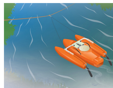
El ADCP de RiverRay utiliza un transductor de superficie plana con tecnología de 4 haces phased-array (PA). Un quinto haz se emplea específicamente para medir la profundidad.
