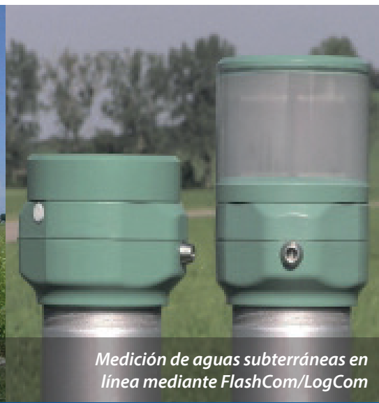
Sonda de contacto eléctrico KLL-Q-2 empleada en aguas subterráneas
