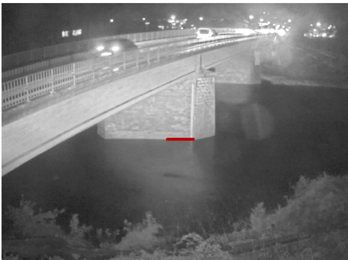
Niveau d'eau détecté optiquement dans des conditions nocturnes.
