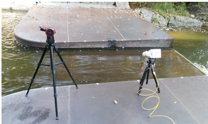
Caméra utilisée pour l'enregistrement des vidéos et Disto S910 pour le relevé des points de contrôle au sol.
