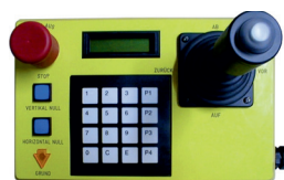
Fig.10: Terminal de commande SEBA
