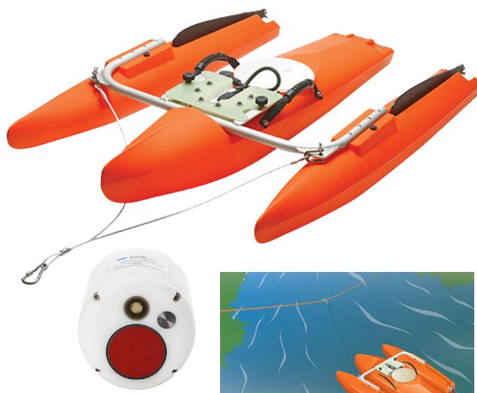
Le RiverRay ADCP utilise un transducteur à réseau phasé à surface plane. Un cinquième faisceau est consacré exclusivement à la mesure de la profondeur
