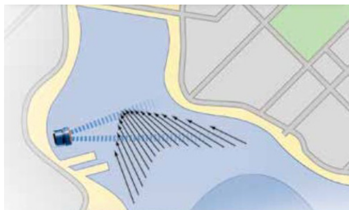
Le ChannelMaster H-ADCP est installé sur une rive ou une structure proche du rivage pour la saisie des données en temps réel de la vitesse, du niveau et du débit.
