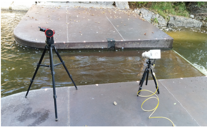
Kamera für die Videoaufnahmen und Disto S910 für die Vermessung der Markierungen.
