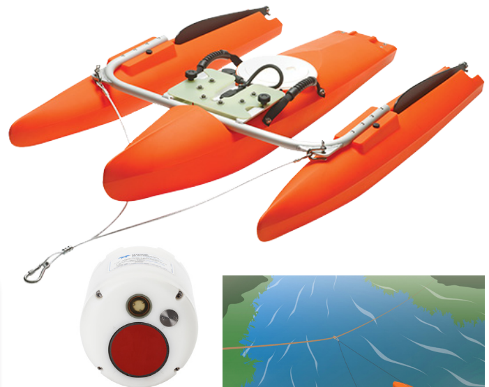
Der RiverRay ADCP verwendet ein phasengesteuertes flaches Sensorfeld (4 Beams). Ein fünfter, dedizierter Strahl wird verwendet, um die Tiefe zu messen.
