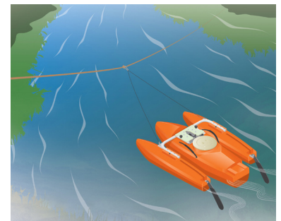
Der RiverRay ADCP verwendet ein phasengesteuertes flaches Sensorfeld (4 Beams). Ein fünfter, dedizierter Strahl wird verwendet, um die Tiefe zu messen.
