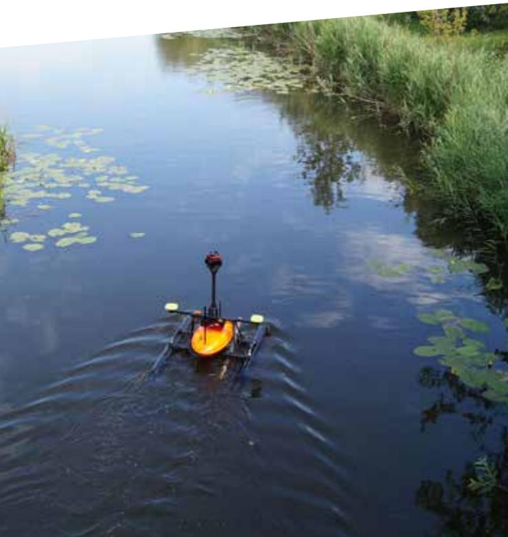
Ablassen von Sensoren, um Tiefenprofile in Gewässern aufzuzeichnen. Die Schnittstellen sind auf die modulare Ergänzung der Sensoren ausgelegt. Die Datenübertragung zur Kontrollstation findet dabei in Echtzeit statt.
