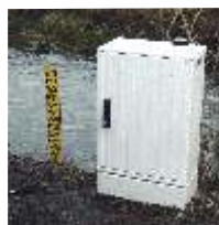
caja protectora con antena puck, modem en el interior
